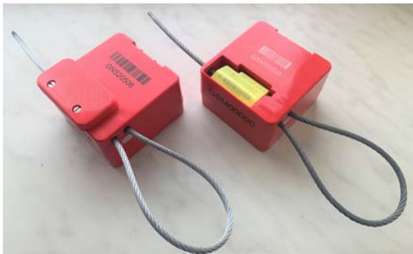
Рис. 3. Электронный замок ИнТЕЛЛЕКТLock (слева) и ЭЛЕКТРОННОЕ ЗАПОРНО-ПЛОМБИРОВОЧНОЕ УСТРОЙСТВО BIGLOCK (справа) в сборе
