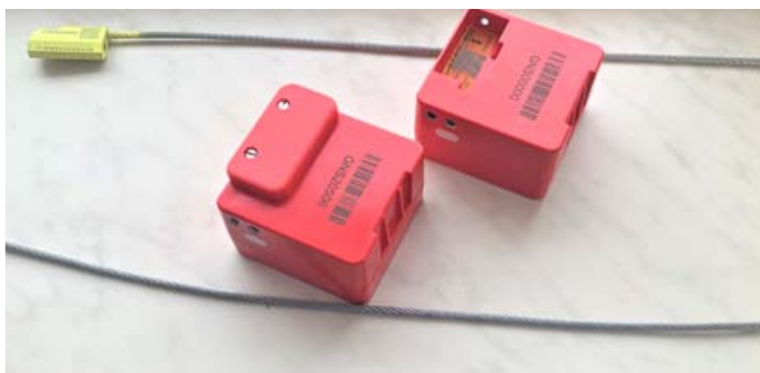
Рис. 4. Электронный замок ИнТЕЛЛЕКТLock с запирающим элементом в виде троса (внизу) и электронное запорно-пломбировочное устройство BIGLOCK с механическим запорно-пломбировочным устройством «Спрут-777» (вверху)
